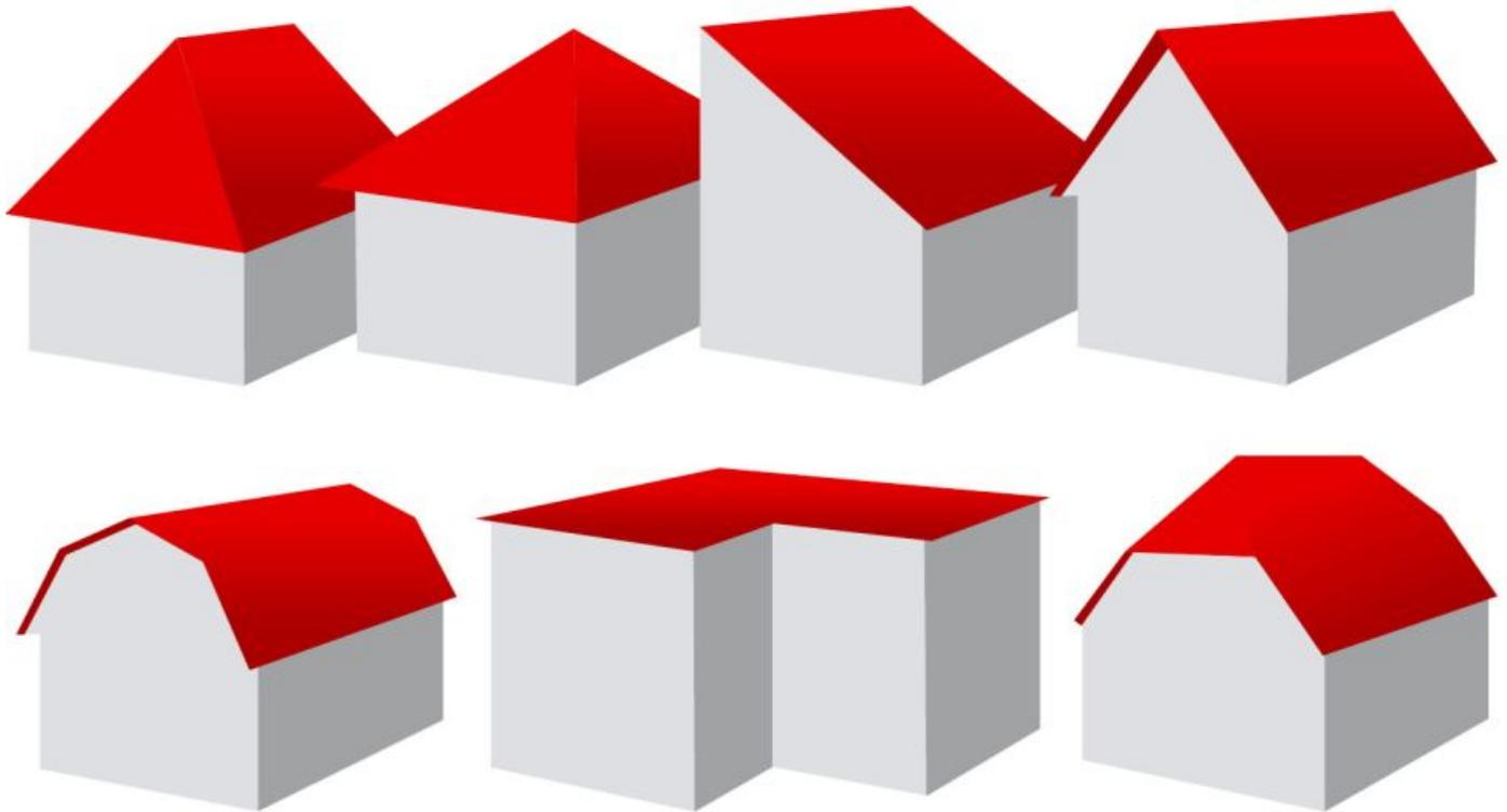
Es gibt unzählige Varianten, aber ein paar Klassiker im Uhrzeigersinn: das Walmdach, das Zeltdach, das Pultdach, das Satteldach, das Krüppelwalmdach, das Flachdach und das Mansarddach. *Illustration: Stefan Dimitrov*
