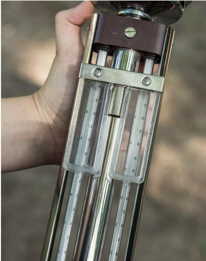
Genauere Messmethode: Mit einem Aspirationspsychrometer kann die Lufttemperatur und die relative Feuchte ziemlich exakt bestimmt werden. Foto: Corinna Guthknecht
